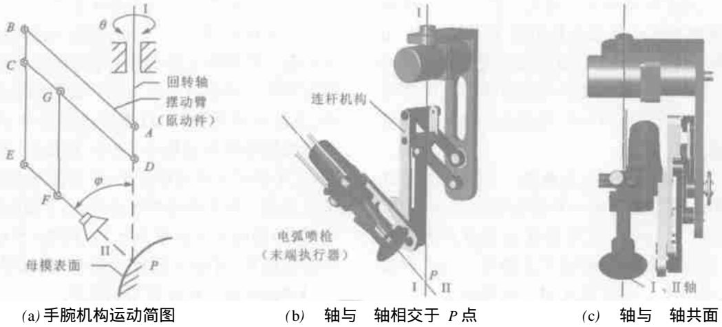
图 2 金属电弧喷涂机器人姿态调节手腕机构
