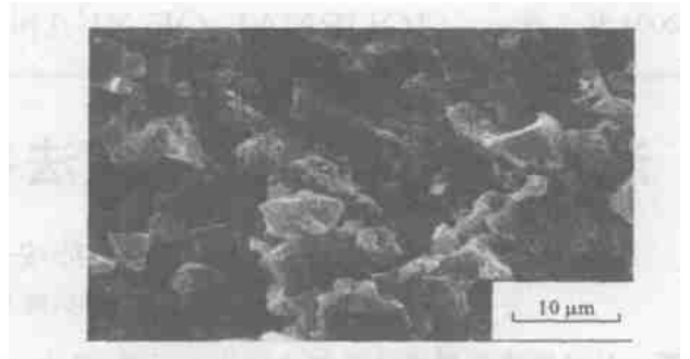
图 5 900 烧结后的断口 SEM 照片
