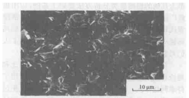
图 8 1 050 烧结后的断口 SEM 照片
