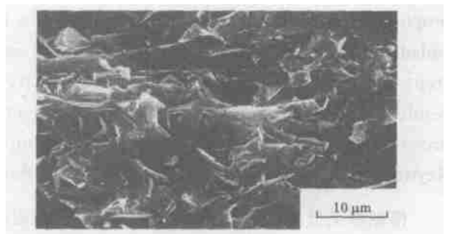
图 7 1 000 烧结后的断口 SEM 照片
